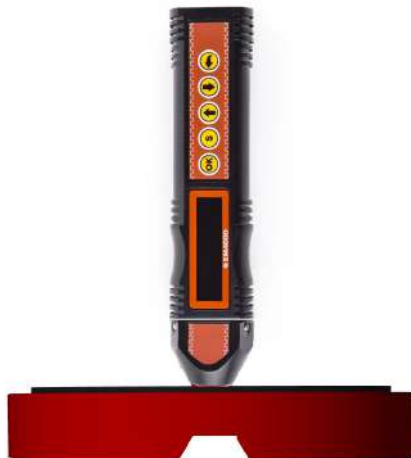
Расположение прибора при калибровке “нуля”
