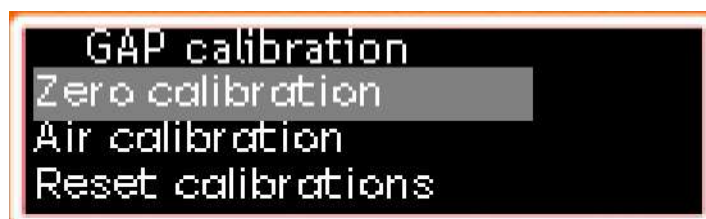
Меню калибровка канала измерения толщины покрытий
