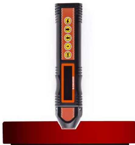
Расположение прибора при калибровке “Толщина”
