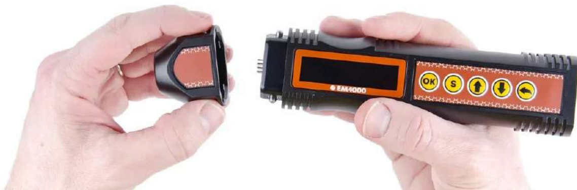
Отсоединение преобразователя EMT40001
